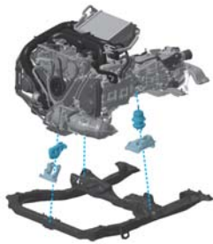
クレードル構造マウント：新採用のパワーユニット搭載方式
